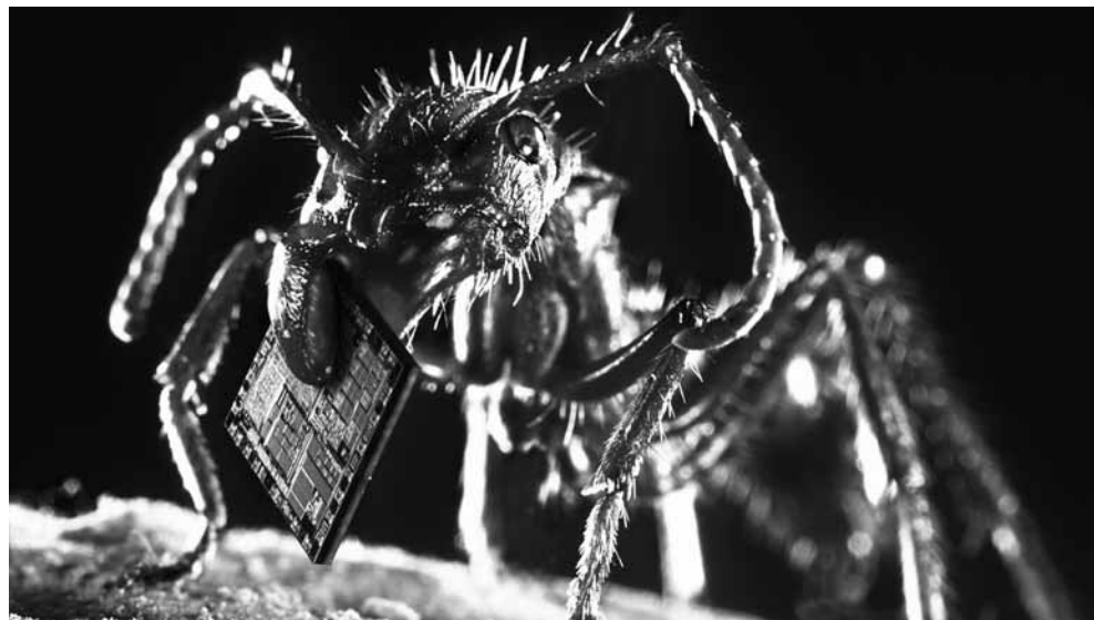
– Diese Ameise trägt einen Chip, der gerade mal 11 mm 2 groß ist. Trotzdem ist dort Platz für 19 200 Funktionen; genug zum Radio hören. Die Halbleiterindustrie ist das Hauptanwendungsgebiet der Nanotechnologie.
